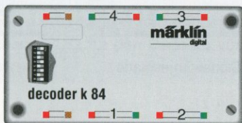
Dauerstrom-Decoder k 84. Links ist der achtpolige Codierschalter im Innern des Decoders angedeutet.
