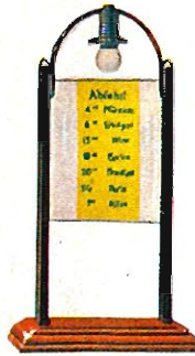
2643 B 2.20 Abfahrt- u. Ankunftsstände mit verschiedenen Aufschriften, elektrisch beleuchtet, Birne 20 Volt 0,15 Amp., 1/2 m Kabel mit Metallsteckern, 9,5 cm lang, 5,5 cm breit, 17,5 cm hoch 2643 Abfahrt- und Ankunftsstände 1.20 wie oben, aber ohne elektr. Beleuchtung
