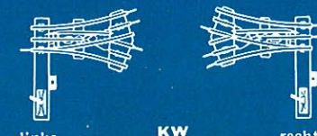
KW Kreuzweiche mit Stellhebel und drehbaren Laternen links rechts
