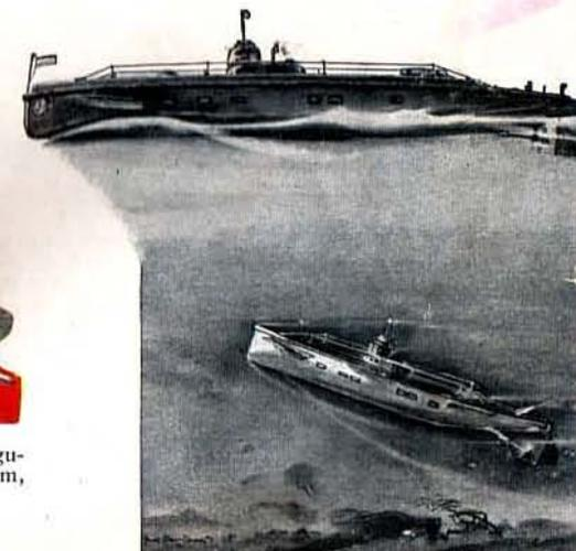
Die Unterseeboote sind vollständig wasserdicht abgeschlossen, so daß ein Untergehen unmöglich ist. Ist das Uhrwerk abgelaufen, so bleibt das Boot an der Wasseroberfläche. Sämtliche Boote sind mit Stützen zum Aufstellen ausgerüstet. Die Boote werden durch ein kräftiges Uhrwerk rasch vorwärts bewegt und tauchen selbsttätig in regelmäßigen Abständen bis in eine Tiefe von etwa 5 cm
