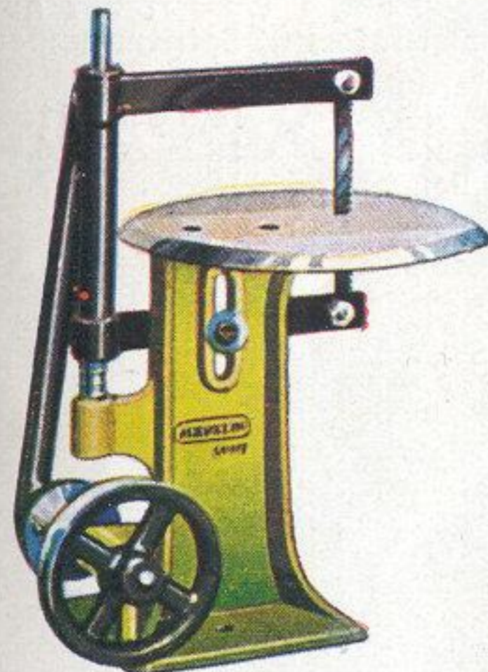
4271 Decoupiersäge 5.50 Exzenterantrieb u. Geradföhrung, Auflageplatte fein geschliffen, 11 cm lang, 9 cm breit, 14 cm hoch
