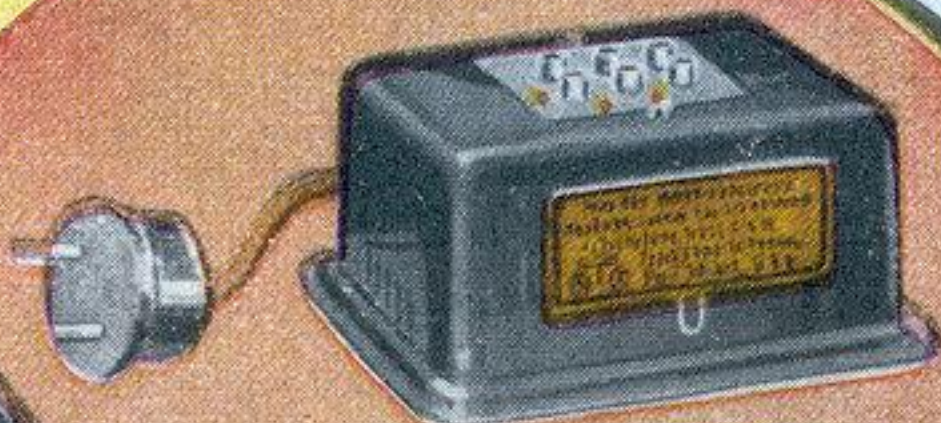
13474 UG 8.50 Transformator-Garnitur für Experimentierzwecke, umsteckbar für Spannungen von 3, 5, 8, 12, 17 u. 20 Volt, Leistung etwa 10 VA. Mit Anschlußkabel und 2 Steckern 13491 S. Zum Anschluß an 110, 125, 150 oder 220 Volt Wechselstrom. Bei Bestellung Spannung angeben!
