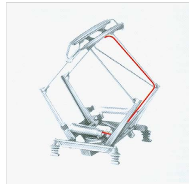
Een schaarstroomafnemer voorzien van een dunne draad
