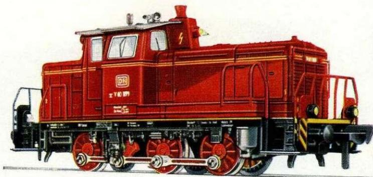
Le prototype de cette locomotive a été construit par les usines Fried-Krupp à Essen; elle est utilisée par la D.B. pour le triage et le trafic de gares. Ses caractéristiques principales sont: poids en service, 54 T; puissance, 650 HP; vitesse en ligne, 60 km/h; vitesse en triage, 30 km/h.
